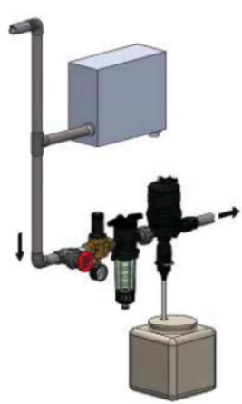
installazione del serbatoio di alimentazione
