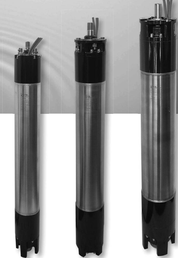
**Liquido di riempimento** acqua limpida con aggiunta di glicole propilenico, specificatamente studiata per la salvaguardia delle acque primarie. Svolge la funzione di raffreddamento antiossidante e anticongelamento, garantisce lo stoccaggio del motore fino a -15°C.
