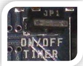
Jumper **ON/OFF TIMER** (zur Ausschaltung des Alarm-Timers) nicht eingeschaltet: Die Sirene und die Blinkleuchte (Mod. UNIT ALARM 2) funktionieren weiter, bis der Alarmzustand behoben ist.
