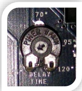
Mit dem Trimmer **DELAY TIME** kann die Dauer (von 20" bis 120") eingestellt werden, nach der die akustische Anzeige und Leuchtanzeige des Alarmes (im Falle einer installierten Blinkleuchte) automatisch abstellen soll.
