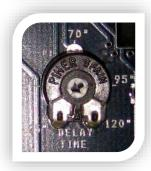
Le trimmer **DELAY TIME** permet de configurer le délai (de 20" à 120") après lequel la signalisation acoustique et visuelle (si le clignotant est installé) sera automatiquement interrompue.
