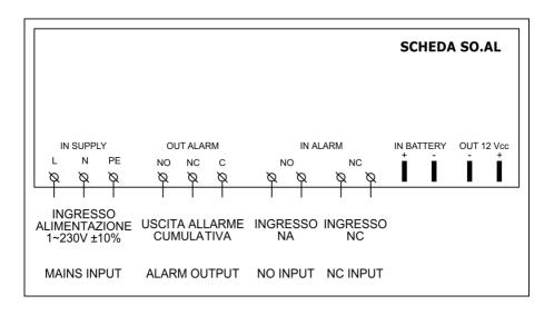
Les bornes NO et NF acceptent exclusivement des contacts secs, c'est-à-dire sans tension comme sorties alarme d'autres tableaux, flotteurs, pressostats, etc.
