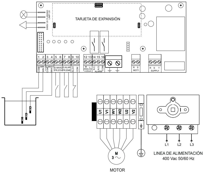
CONEXIÓN TRANSDUCTOR DE PRESIÓN
