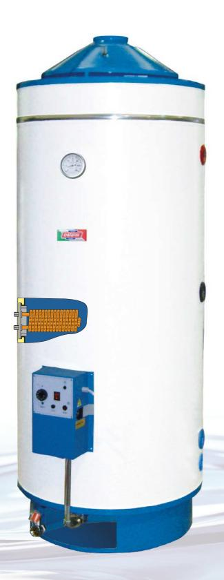
Gli scaldabagni della serie BTG OVO sono gli stessi apparecchi della serie BG OVO ma provvisti oltre che del normale bruciatore a gas, di un'integrazione termo. L'integrazione termo consiste in un serpentino in rame alettato posto all'interno dello scaldabagno che funge da scambiatore di calore.
